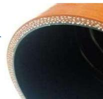
Manguera de silicona de alta calidad exterior reforzada color ladrillo, recubierta interiormente con silicona especial color negro para aceites y bencinas. Lo que la hace más resistente, flexible y duradera. Soporta temperaturas desde -40 ° C - hasta 220 ° C. Sus telas son de NOMEX o ARAMIDA, mucho más resistente que el tradicional Polyester.
